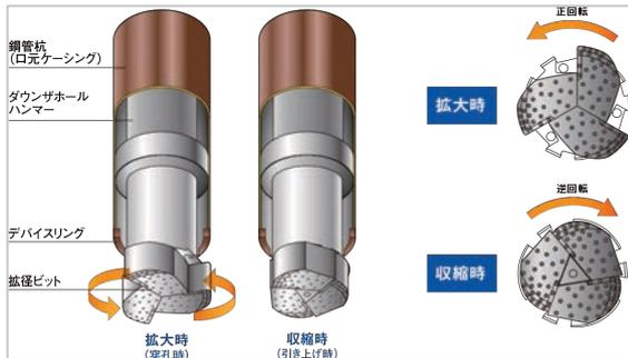
図-5 拡径式ダウンザホールハンマー工法概要図
