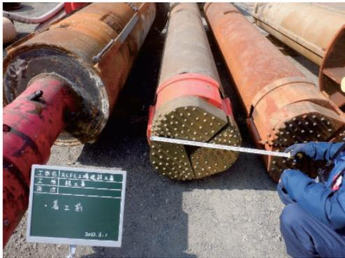
写真-4 拡径式ダウンザホールハンマー先端ビット
