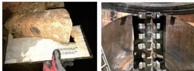
写真-9 カッタービット実施摩耗量 写真-10 到達時のビット摩耗
