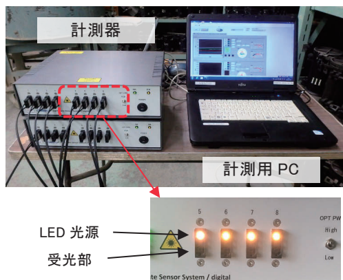
写真-2 充填検知システムの構成
