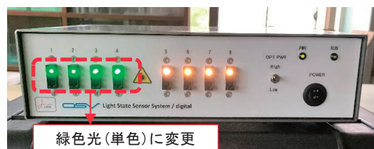
写真-3 LED 光源を変更 (ch.1~ch.4) した計測器
