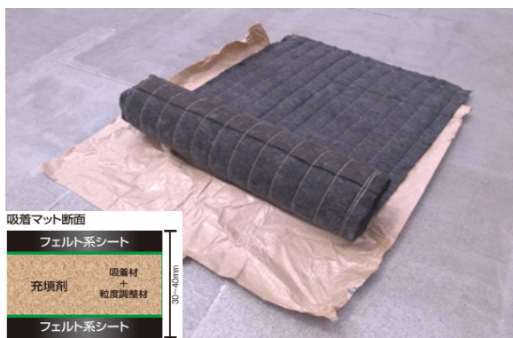
図-1 重金属吸着マットの外観・構造
