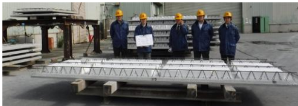
写真-3 ハーフ PCa 床版（工場検査時）
