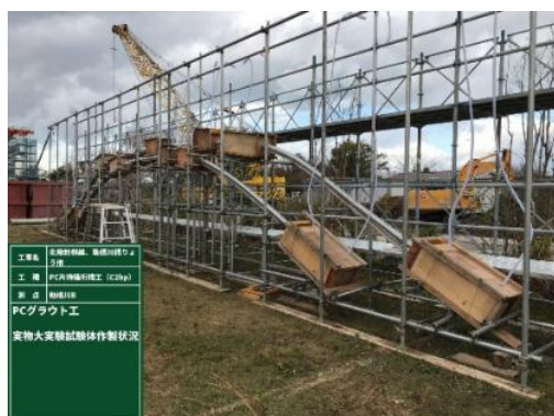
写真-14 PC グラウト実物大実験試験体
