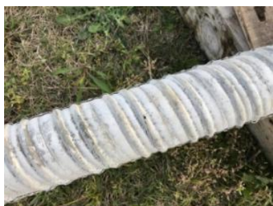
写真-17 PC グラウト充填性確認状況
