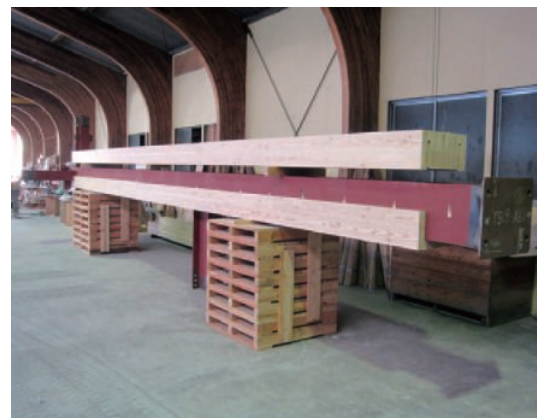
写真-3 耐火集成材加工状況 (一般部)
