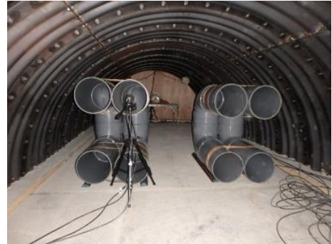
写真-4 円形断面音響管の設置
