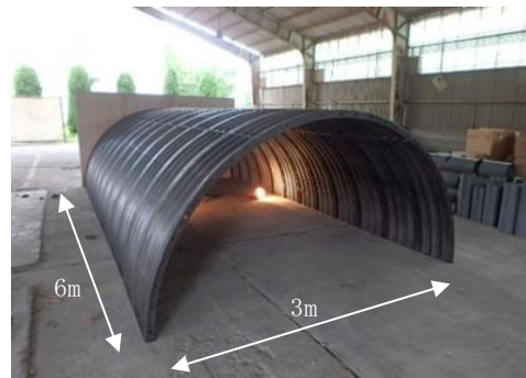
写真-1 縮尺モデル実験空間
