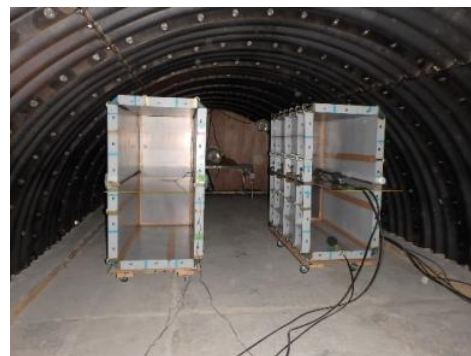
写真-5 矩形断面音響管の設置
