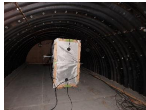
写真-8 抵抗体を付加した音響管
