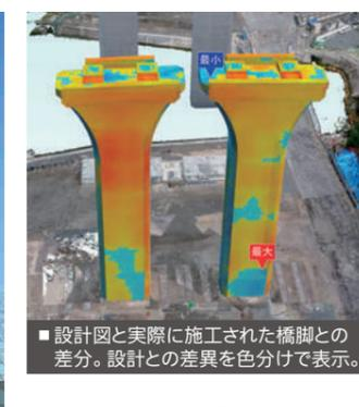
■ 設計図と実際に施工された橋脚との差分。設計との差異を色分けで表示。
