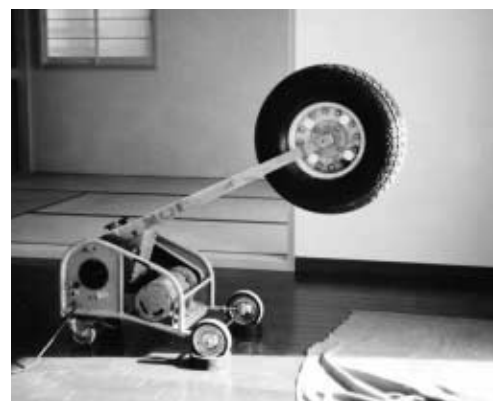
重量床衝撃音測定状況
